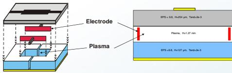
← Schéma de principe et premiers essais d'une maquette de filtre micro-onde reconfigurable par injection d'un plasma dans une cavité du substrat. De nouvelles structures sont à l'étude pour corriger certains des défauts observés (hétérogénéité du plasma, absorption, ...)
