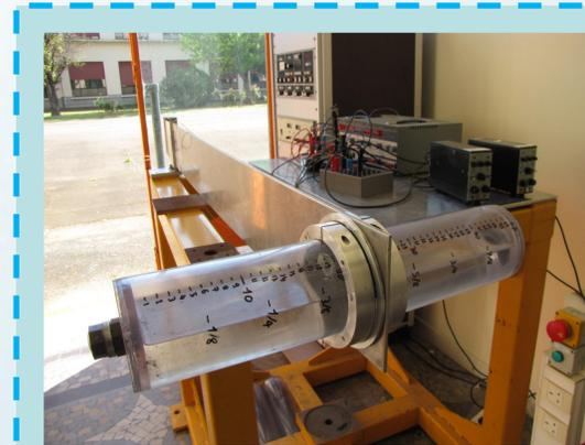
Fig.1 : Plaque équipée d'actionneurs piézo-électriques et d'un réservoir cylindrique en bout . Atténuation active des interactions des modes de ballonnement et des vibrations structurelles (2012, LAAS & ISAE)
